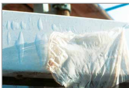
Samoljepljivi zaštitni film postavljen na anodirani aluminij s mjehurićima i naborima
