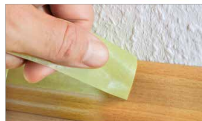
Kidanje imitacije drva; velika opasnost pri primjeni standardne maskirne trake u slučaju uklanjanja u vlažnom stanju. Kod trake tesa® 4334 za precizno maskiranje® ne dolazi do oštećenja.
