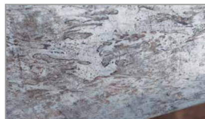
Površinske promjene zbog kondenzacije na pocinčanom limu
