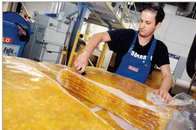
Priprema proizvodnje smjese ljepila: otpakiravanje bala prirodne gume
