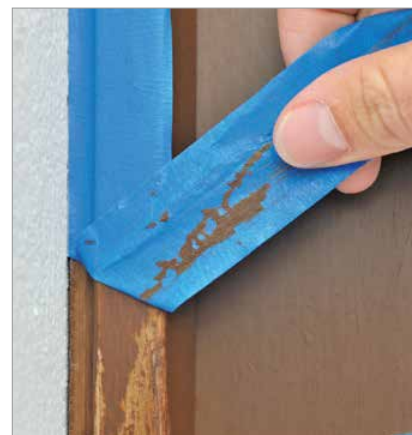
Lak koji se odljepljuje pri korištenju proizvoda prekomjerne snage lijepljenja. Preporuke u tim slučajevima: tesa® 4439
