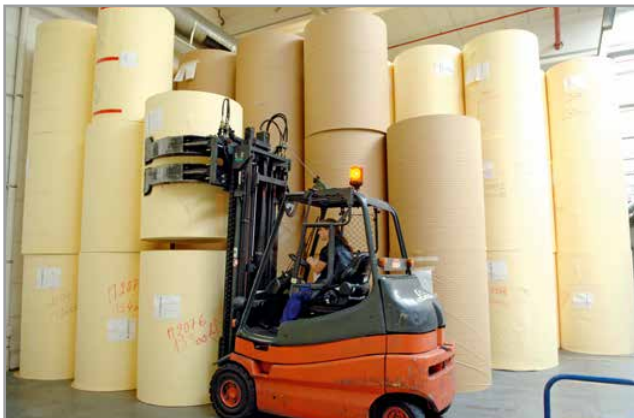
Sirovine za proizvodnju maskirnih traka: velike role naboranog papira
