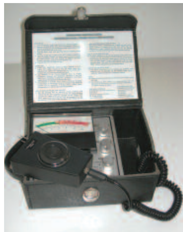
Primjer mjerača vlage opremljen senzorom sa jastučićem.
