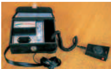
Mjerač vlage: ovim instrumentom je moguće izmjeriti postotak vlažnosti stakloplastike ili drveta.
