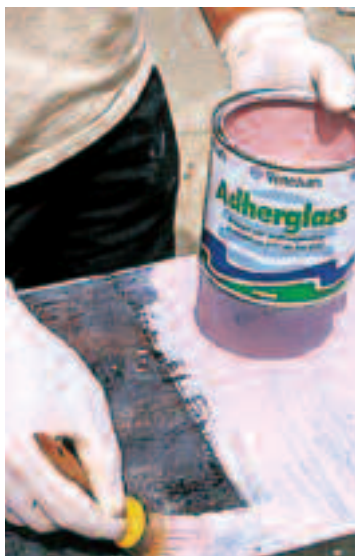
Uronjene površine: prije antivegetativne boje nanijeti jedan premaz Adherglass. Površine iznad vodene linije: prije završnog laka Gel Gloss Pro nanijeti jedan sloj Plastolite Pro.
