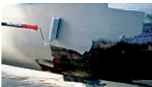
Na pripremljenu površinu nanesite Hempel's Underwater Primer
